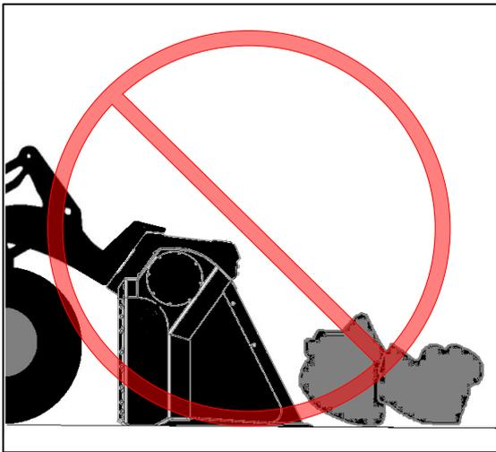
Sicherstellen, dass keine großen Steine in den Löffel geraten, um einen übermäßigen Verschleiß zu vermeiden.
