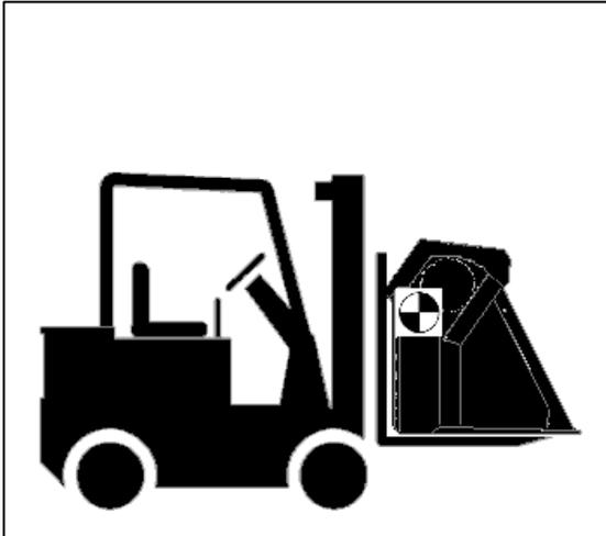
Bei Verwendung eines Gabelstaplers immer an der Wellenseite unter die Maschine greifen.
