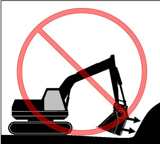
Material nicht mit den Wellen des Transformers schieben. Es besteht die Gefahr der Beschädigung der Lagerdichtungen.
