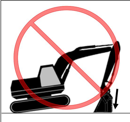
Den Transformer beim Fahren/Transport des Trägergeräts nicht als Stütze einsetzen. Es besteht die Gefahr der Beschädigung des Transformers.
