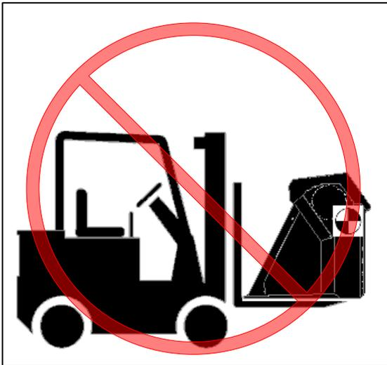
Die Maschine nie an der Plattenseite heben. Wird der Transformer an der Plattenseite gehoben, kann er umkippen, da der Schwerpunkt hoch und nach hinten gerichtet ist.
