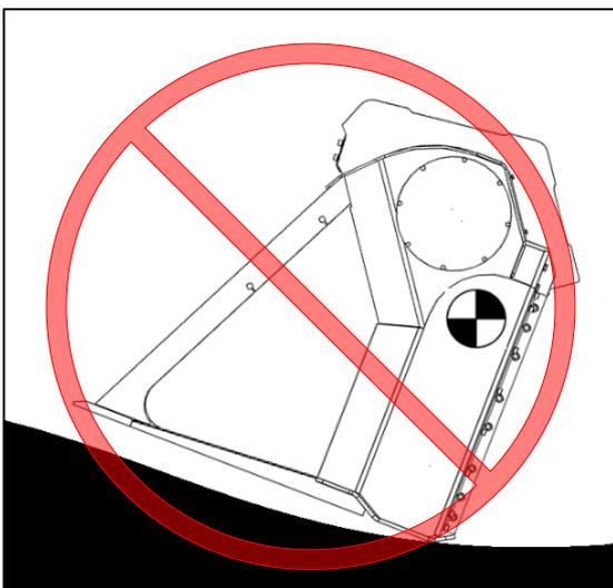
Den Transformer nie auf einem abschüssigen oder weichen Untergrund vom Trägergerät oder einer Winde lösen, da er sonst umkippen kann. Vorsicht beim Lösen der Bänder zur Transportsicherung der Maschine. Es besteht die Gefahr des Umkippens.
