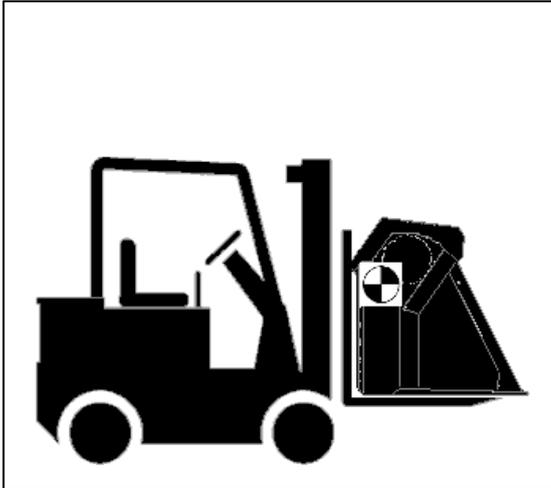
Bei Verwendung eines Gabelstaplers immer an der Wellenseite unter die Maschine greifen. Diese Abbildung zeigt den Schwerpunkt der Maschine.
