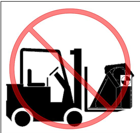
Die Maschine nie an der Plattenseite heben. Wird die Maschine an der Plattenseite gehoben, kann sie umkippen, da der Schwerpunkt dann hoch und nach vorn gerichtet ist.
