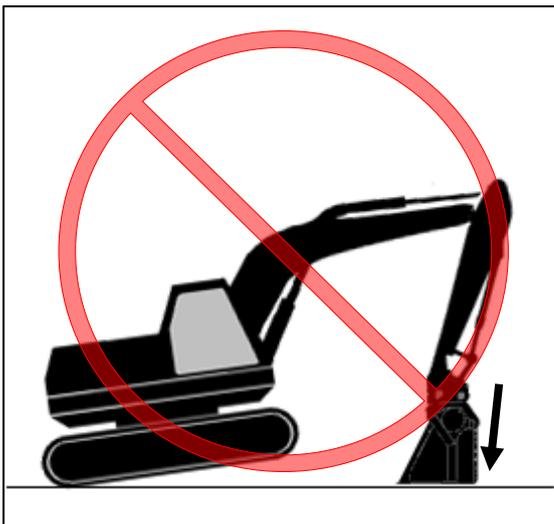
Den DC-Schaufelseparator beim Fahren/Transport des Trägergeräts nicht als Stütze einsetzen. Es besteht die Gefahr der Beschädigung des Schaufelseparators.
