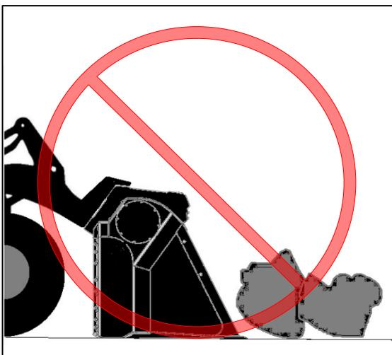
Sicherstellen, dass keine großen Steine in die Maschine geraten, um einen übermäßigen Verschleiß zu vermeiden.
