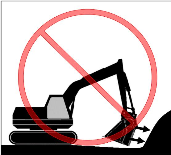
Material nicht mit den Wellen der Maschine schieben. Es besteht die Gefahr der Beschädigung der Lagerdichtungen.
