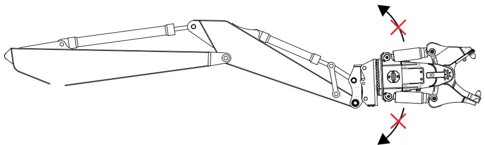
Den Betrieb des Anbaugeräts in den Endlagen des Löffel- und des Stielzylinders vermeiden.
