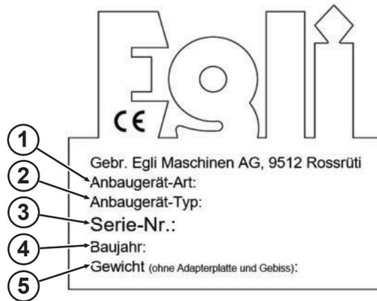
Das auf dem Anbaugerät angebrachte Typenschild enthält folgende Angaben:
