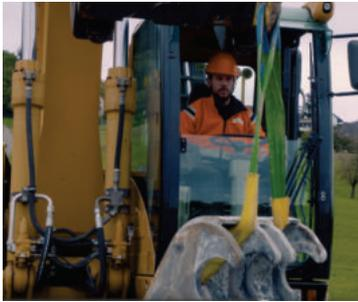
b) Altes Gebiss mit Hilfe von geeigneten Anschlagmitteln anheben.
