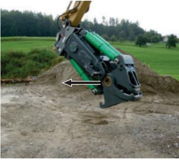
f) Gebiss durch Löffelzylinderbewegung von Boden aufnehmen und möglichst an Anschlag fahren. So wird gewährleistet, dass dieses durch das eigene Gewicht an den unteren Aufnahmerollen anliegt.
