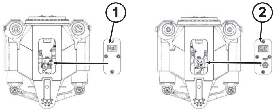
Am Gehäuse des Anbaugeräts befindet sich auf jeder Seite eine Serviceöffnung, um die innenliegenden Komponenten zu erreichen.
