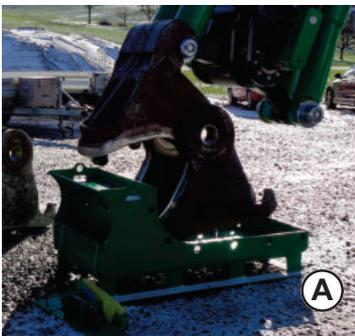
h) Das Ablegen des Gebisses sollte idealerweise möglichst weit entfernt vom Trägergerät geschehen. Das Gebiss zu Boden führen, bis es aus der oberen Aufnahmeachse gleitet (Stiel strecken). Damit Aufnahmelaschen im idealen Winkel zur Wiederaufnahme liegen, Ablage entweder im Transportgestell (A) oder mit Ablagerohr (B) im Gebiss.
