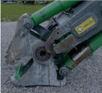
g) Das Gebiss wird mittels der Funktion „Betonbeisser schliessen“ ausgestossen. Das Anbaugerät in eine 45°-Position fahren, dadurch gleitet das Gebiss zuerst aus der unteren Aufnahmeachse.
