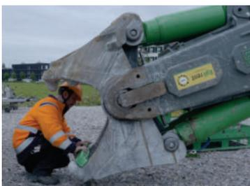
e) Ablagerohr in die Gebissöffnung einlegen!
