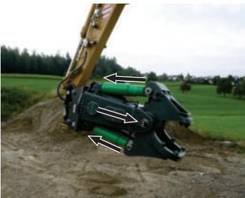
h) Das Gebiss mit der Funktion „Betonbeisser öffnen“ einziehen und so die Arbeitszylinder ganz einfahren. Die Verriegelungsbolzen mit Funktion „Betonbeisser drehen“ vollständig einfahren.
