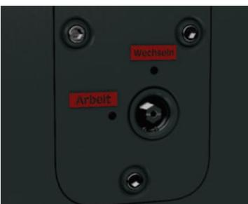
i) Die Wechseleinrichtung mit dem 24er-Ringschlüssel von Pos. „Wechsln“ um 90° auf Pos. „Arbeiten“ stellen.
