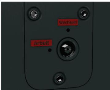
d) Die Wechseleinrichtung mit 24er-Ringschlüssel von Position „Arbeiten“ um 90° auf Position „Wechseln“ stellen.
