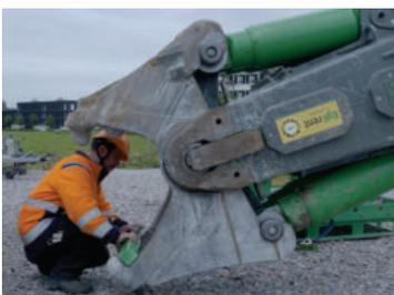
e) Ablagerrohr in die Gebissöffnung einlegen!
