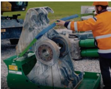
b) Zurrgurte am Wechselgebiss und Transportgestell lösen und entfernen.
