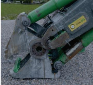
g) Das Gebiss wird mittels der Funktion „Betonbeisser schliessen“ ausgestossen. Das Anbaugerät in eine 45°-Position fahren, dadurch gleitet das Gebiss zuerst aus den unteren Aufnahmeachse.
