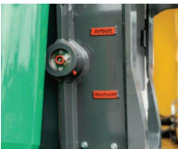
d) Die Wechseleinrichtung mit 24er-Ringschlüssel von Position „Arbeiten“ um 90° auf Position „Wechsln“ stellen.
