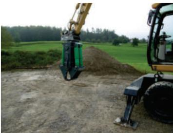
a) Das Gebiss mit geschlossener Gebisshälfte gegen das Trägergerät parallel ausrichten.
