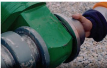
e) Aufnahmerollen auf Freilauf kontrollieren und reinigen.
