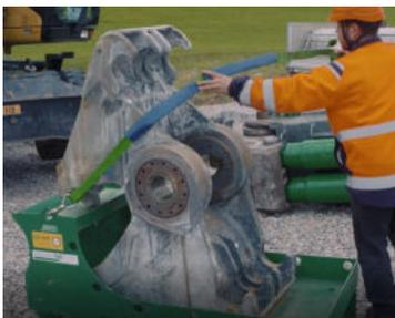
b) Spannsatz am Wechselgebiss und Transportgestell lösen und entfernen.
