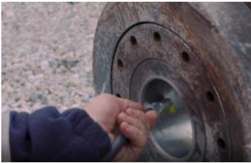
c) Lagerstellen am Wechselgebiss reinigen und fetten.
