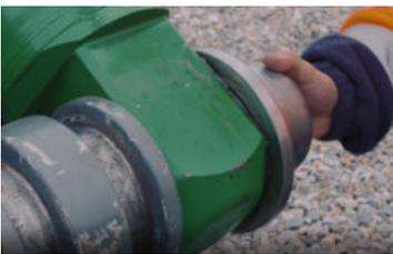
e) Aufnahmerollen auf Freilauf kontrollieren und reinigen.
