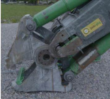
g) Das Gebiss wird mittels der Funktion „Betonbeisser schliessen“ ausgestossen. Das Anbaugerät in eine 45°-Position fahren, dadurch gleitet das Gebiss zuerst aus den unteren Aufnahmehaken.
