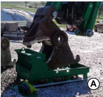
h) Das Ablegen des Gebisses sollte idealerweise möglichst weit entfernt vom Trägergerät geschehen. Das Gebiss zu Boden führen, bis dieses aus den oberen Aufnahmehaken gleitet (Stiel strecken). Damit Aufnahmelaschen im idealen Winkel zur Wiederaufnahme liegen, Ablage entweder im Transportgestell (A) oder mit Ablagerohr (B) im Gebiss.
