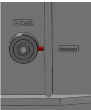
d) Die Wechseinrichtung mit 24er-Ringschlüssel von Position „Arbeiten“ um 90° auf Position „Wechseln“ stellen.
