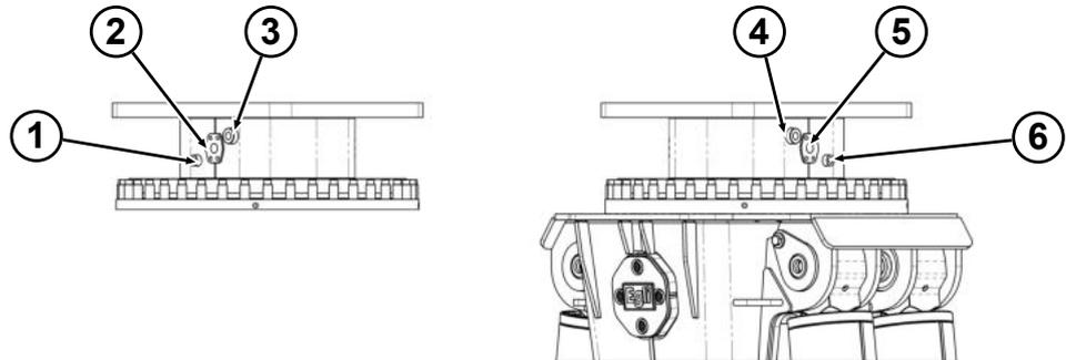
Zwischenadapter mit integrierten Schlauchanschlüssen und Zwischenkasten
