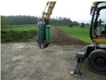
a) Das Gebiss mit geschlossener Gebisshälfte gegen das Trägergerät parallel ausrichten.
