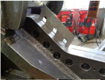
m) Sollte der Schnittspalt nicht den Toleranzen entsprechen, die Messer nochmals lösen und Einstellbleche hinzufügen oder entfernen.
