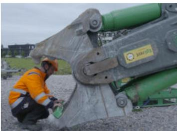
e) Ablagerrohr in die Gebissöffnung einlegen!
