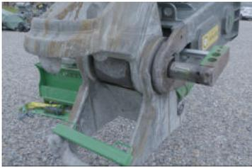
f) Mit der Funktion „Betonbeisser drehen“ die Wechsler-Bolzen komplett ausfahren. Während des Ausstossens des Gebisses die Funktion „Betonbeisser drehen“ dauerhaft betätigen, damit die Wechslerbolzen nicht einfahren können.
