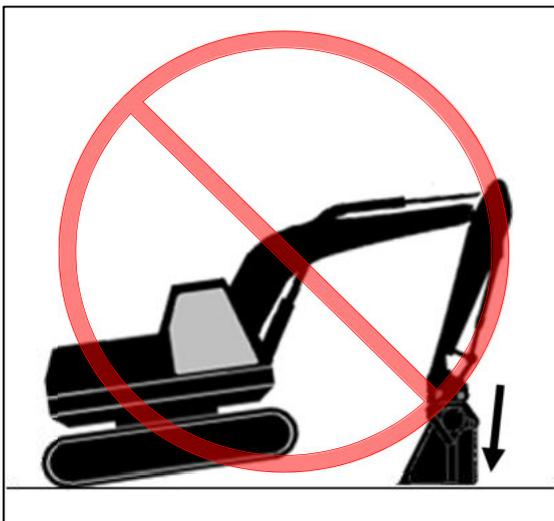
Die Maschine beim Fahren/Transport des Trägergeräts nicht als Stütze einsetzen. Es besteht die Gefahr der Beschädigung des ALLU Transformers.
