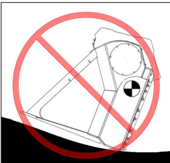
Die Maschine nie auf einem abschüssigen oder weichen Untergrund vom Trägergerät oder einer Winde lösen, da sie sonst umkippen kann. Vorsicht beim Lösen der Bänder zur Transportsicherung der Maschine. Es besteht die Gefahr des Umkippens.
