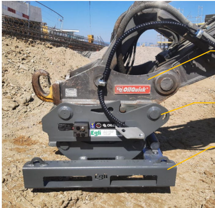
Abb. 6.1.1-2: Absetzen des Drehwerksandwichs (Symbolbild)
