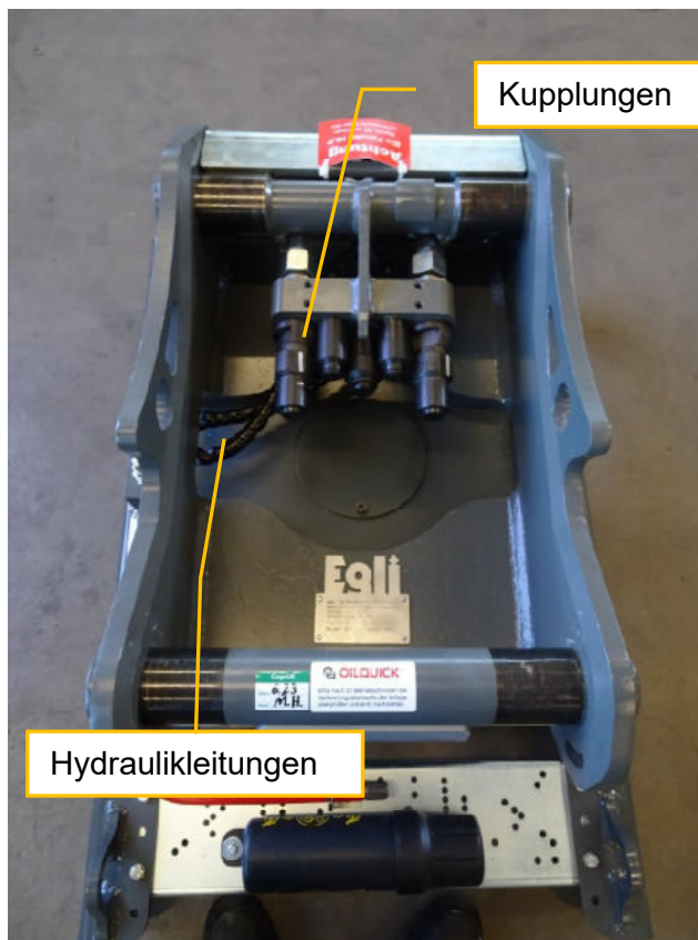
Abb. 4-2: Kupplungen und Hydraulikleitungen am Drehwerksandwich
