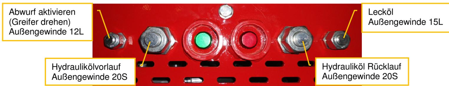
Abb. 6.3-2: Anschlüsse an der Rückwand des Hydraulik-Magneten
