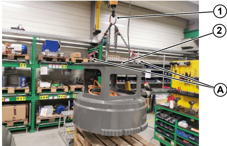
Transport eines Hydraulikmagneten ohne Adapterplatte
