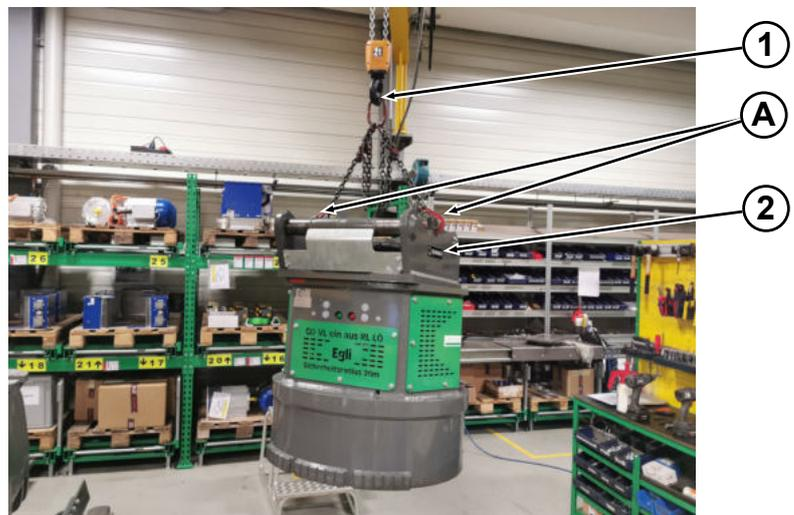
Transport eines Hydraulikmagneten mit Adapterplatte
