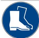
Sicherheitsschuhwerk mit Stahlkappe und durchtrittsicherer, ölfester Sicherheitssohle.
