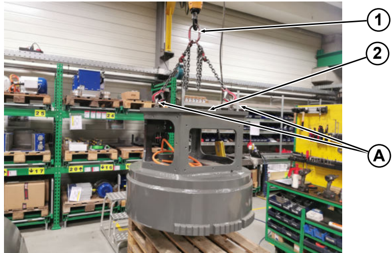
Transport eines Hydraulikmagneten ohne Adapterplatte
