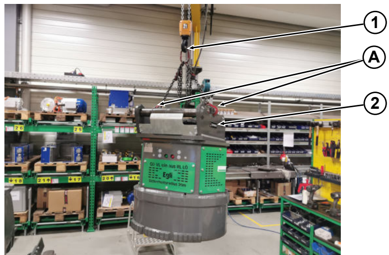
Transport eines Hydraulikmagneten mit Adapterplatte
