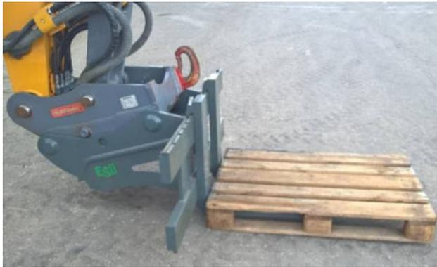
**Abb. 8.1-2: Ladeeinheit unterfahren**
