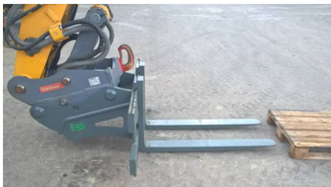
Abb. 8.1-1: vor die Ladeeinheit fahren
