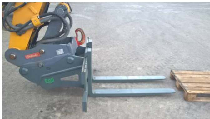
Abb. 8.1-1: vor die Ladeeinheit fahren
