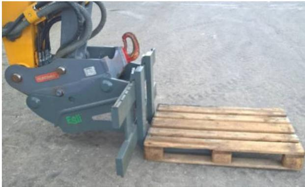
**Abb. 8.1-2: Ladeeinheit unterfahren**
