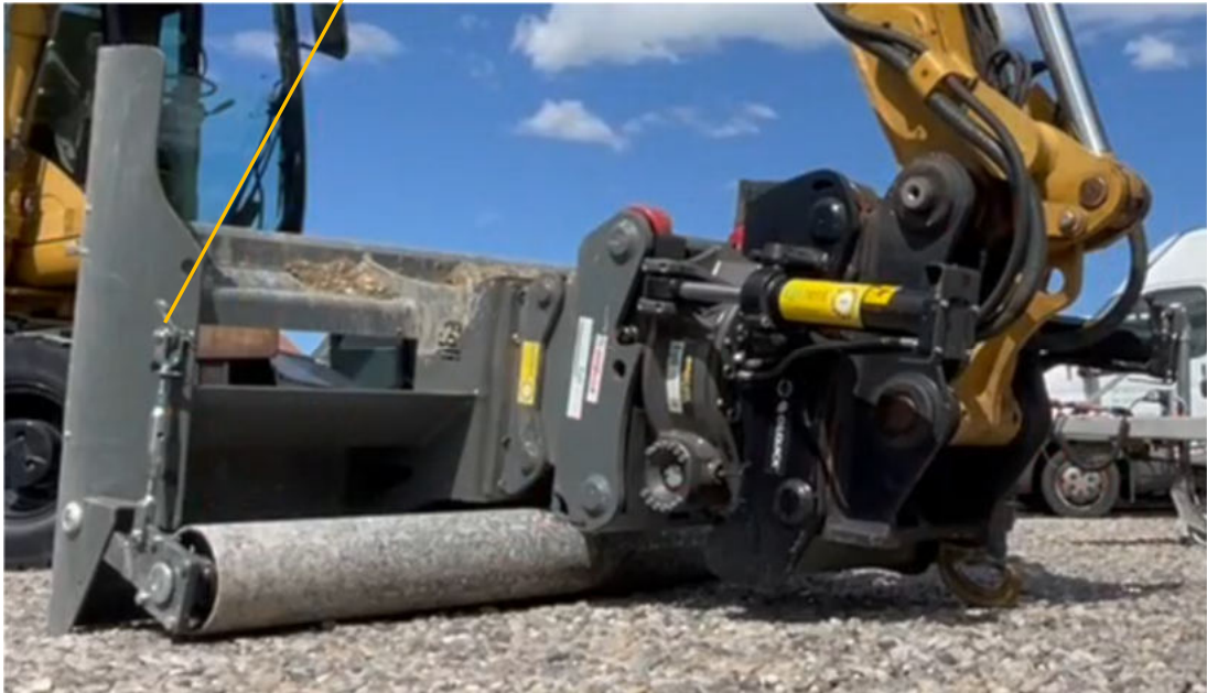
Abb. 8.1.1-4: Spindel oben befestigen
