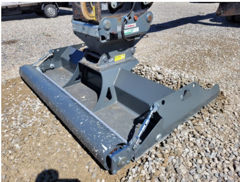
Abb. 8.1.2-7: Rolle unten und einsatzbereit
