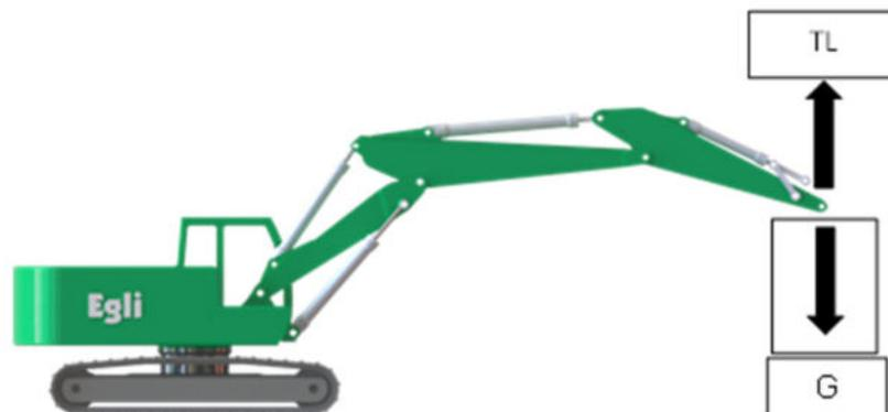
Um die Dichte  $\rho$  des Schüttgutes zu ermitteln, muss die neu berechnete Traglast ( $TL_{\text{Neu}}$ ) durch den Inhalt L (SAE) dividiert werden und mit dem Faktor 1000 (1 Liter = 1 dm<sup>3</sup> => 1000 Liter = 1 m<sup>3</sup>) multipliziert werden.
