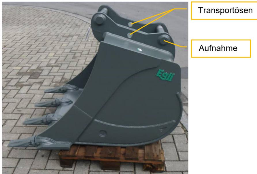
Abb. 5.1-1: Absetzen des Sieblöffels
