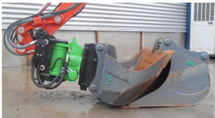
**Abb. 5.2-3: Absetzen des Sieblöffels mit Aufnahmelaschen**
