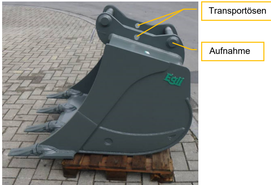
Abb. 5.1-1: Absetzen des Sieblöffels
