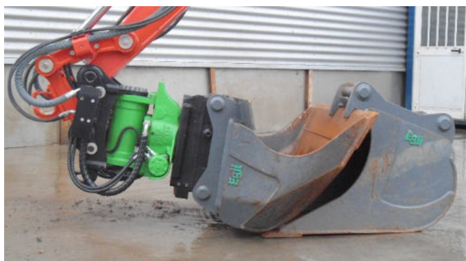
Abb. 5.2-3: Absetzen des Sieblöffels mit Aufnahmelaschen
