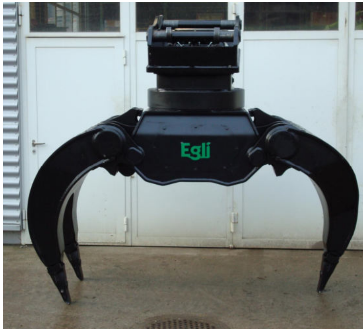
Abb. 5-2: Absetzen des Steingreifers
