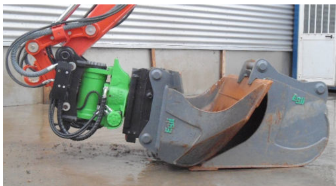
Abb. 5.2-3: Absetzen des Tieflöffels mit Aufnahmelaschen
