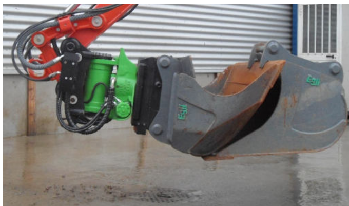
Abb. 5.2-2: Transport des Tieflöffels mit Aufnahmelaschen
