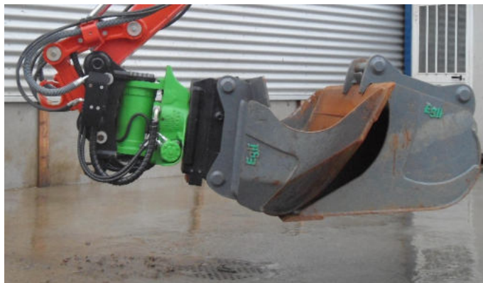
Abb. 5.2-2: Transport des Trapezlöffels mit Aufnahmelaschen
