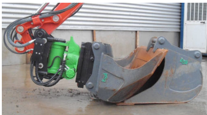
Abb. 5.2-3: Absetzen des Trapezlöffels mit Aufnahmelaschen
