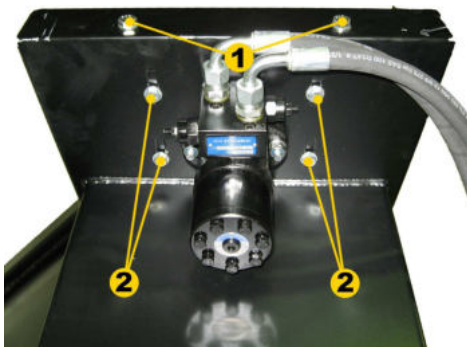
Abbildung 4. Stellschrauben (1) und Befestigungsschrauben (2).
