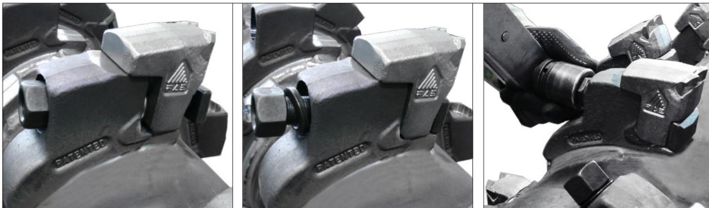
Wenn es notwendig ist auf das Werkzeug zu schlagen, um die Montage bzw. die Demontage zu erleichtern, verwendet Sie nur einen Kupferhammer.
