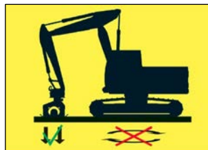
Abbildung 2: Abstützen auf dem Anbaugerät zur Veränderung der Baggerposition ist nicht zulässig
