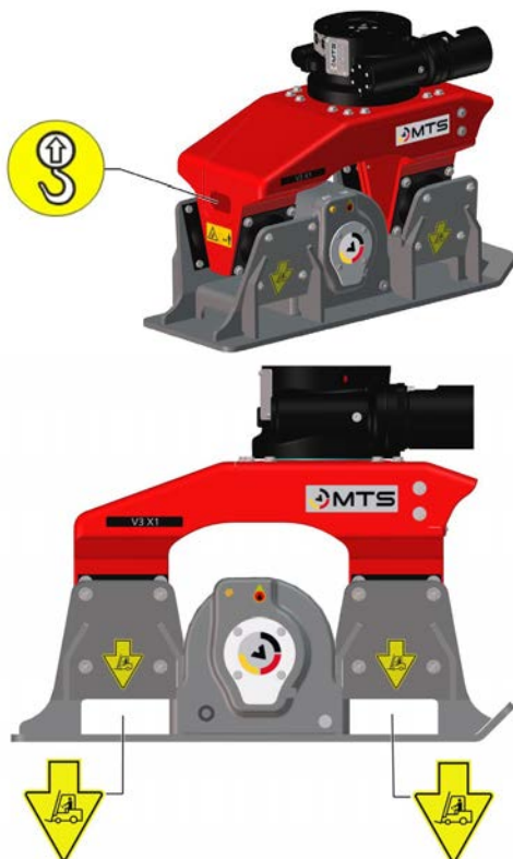
Abbildung 14: Anschlagpunkte und Hubgabelaufnahme
