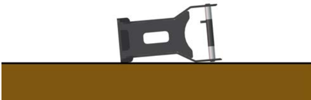
Abbildung 10: Ablageposition MTS-Verdichterfußplatte für den Transport
