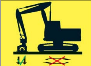
Abbildung 2: Abstützen auf dem Anbaugerät zur Veränderung der Baggerposition ist nicht zulässig
