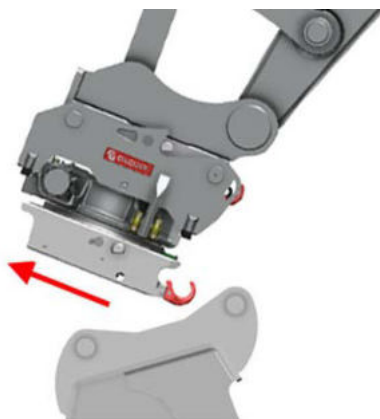
Abbildung 65: Rotationswechsler vom Anbaugerät trennen
