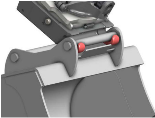
Abbildung 12: loses Anbaugerät in der Fallsicherung
