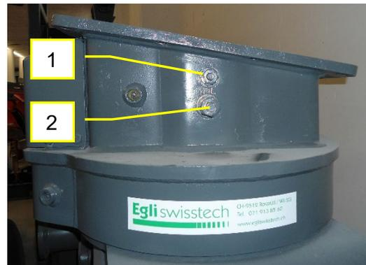
Abb. 6.2-2: Anschlüsse am Drehwerk
