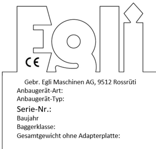
Abb. 4.3-1: Abbildung eines Typenschildes für einen Sortiergreifer
