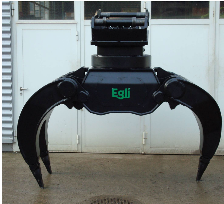
Abb. 5-2: Absetzen des Steingreifers
