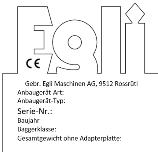
Abb. 4.3-1: Abbildung eines Typenschildes für einen Steingreifer
